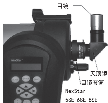
图 3-2 光学观测部结构
