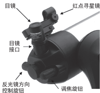
图 3-3 NexStar4SE 光学观测部结构
