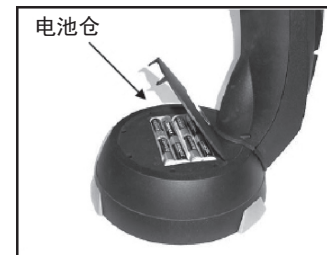
图 3-1 NexStar 能利用 8 节 AA 电池驱动
