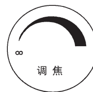
图 3-4 NexStar 调焦旋钮旋转方向
